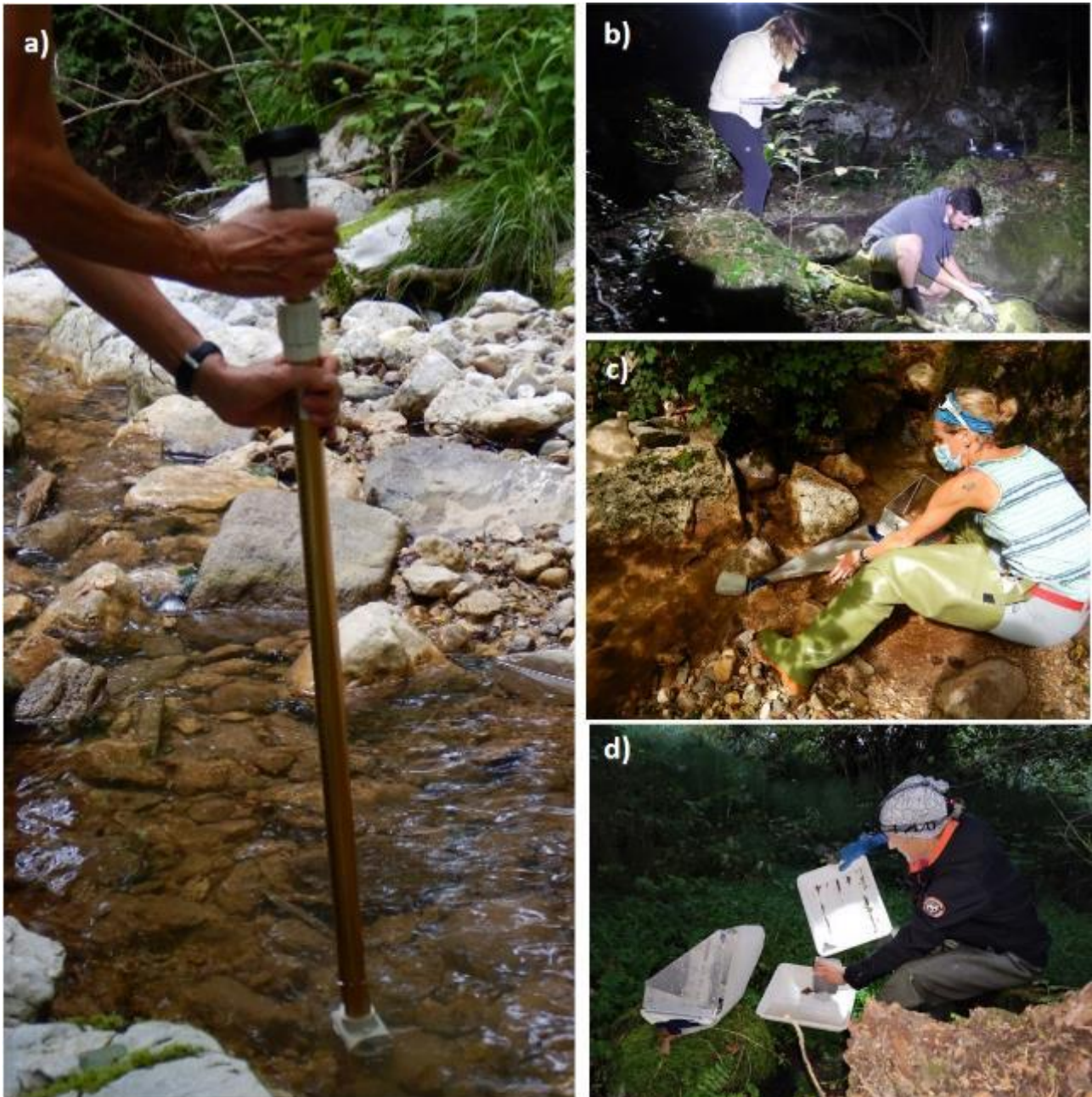
Figura 2.1 – Attività di rilievo habitat: a) misurazione di velocità della corrente; b) misurazione delle variabili fisico-chimiche delle acque; c) d) raccolta di un campione di macroinvertebrati.
